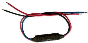
CDM-I nouveaux Module intermédiaire de commande de DAS Il est nécessaire à chaque DAS à commander, sauf pour le dernier DAS de la ligne, qui doit être équipé du module fin de ligne de commande de DAS (CDMOD-F).
