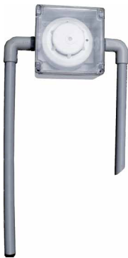
BDG Boîtier détecteur de gaine pour OX-8 Le boîtier de gaine de ventilation est conçu pour le détecteur OX-8. Cet appareil est destiné à être utilisé directement sur des systèmes de chauffage, de ventilation et des conduits de climatisation.
