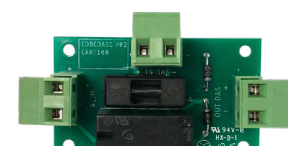
CDBEDAS-E Module de commande de DAS à émission Ce module nécessite l'utilisation d'une alimentation externe. Il permet la commande de DAS lorsque la puissance nécessaire est supérieure à celle fournie par la centrale ou si la tension de commande des DAS est différente de 24V.
