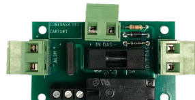
CDBEDAS-R Module de commande de DAS à rupture Ce module nécessite l'utilisation d'une alimentation externe. Ce module est indispensable pour la commande de DAS à rupture.
