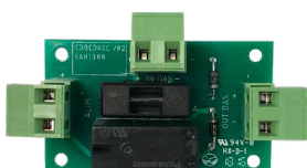
CDBEDAS-E Module de commande de DAS à émission Ce module nécessite l'utilisation d'une alimentation externe. Il permet la commande de DAS lorsque la puissance nécessaire est supérieure à celle fournie par la centrale ou si la tension de commande des DAS est différente de 24V.
