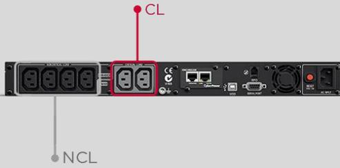
Les utilisateurs peuvent configurer les paramètres de charge critique / non critique (CL / NCL) via le logiciel. Lorsque l'alimentation de la batterie est insuffisante lors d'une panne de courant, les prises NCL peuvent être coupées pour préserver la puissance nécessaire à l'extension des périphériques critiques.
