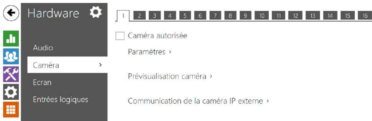
**2N® Indoor View** permet de configurer jusqu'à 16 caméras externes pour diffuser des appels vidéo. Des caméras IP externes courantes prenant en charge un flux RTSP avec les codecs MJPEG ou H.264 peuvent être connectées. La résolution maximale du flux reçu est de 1920 x 1080. Le nombre d'images par seconde recommandé est de 30 images par seconde dans les deux cas. Des taux de trame plus élevés peuvent entraîner des effets indésirables (flux moins fluide).
