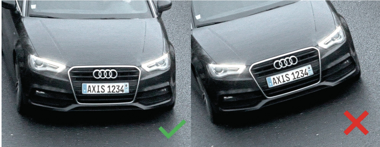
Figure 10. La caméra doit être alignée de manière à ce que la plaque d'immatriculation soit parallèle au bord de l'image.
