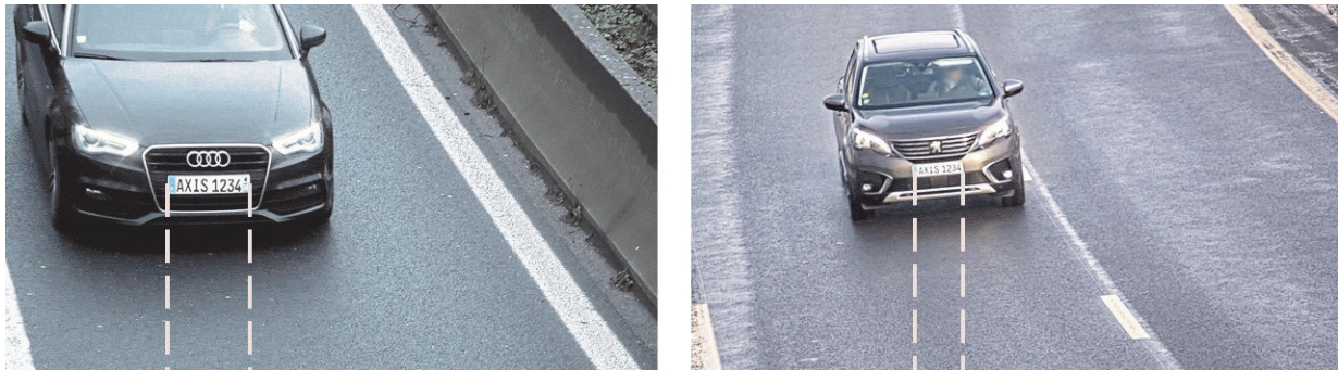
Figure 6. Le nombre de pixels sur la largeur de la plaque d'immatriculation dépend de la résolution de la caméra et de la largeur de la scène. Dans cet exemple, une caméra d'une résolution de 1080x1920 pixels est (à gauche :) zoomée sur une voie (4 m de large) et (à droite :) dézoomée pour couvrir presque deux voies (6,5 m de large). La plaque d'immatriculation couvre 250 pixels et 154 pixels, respectivement.
