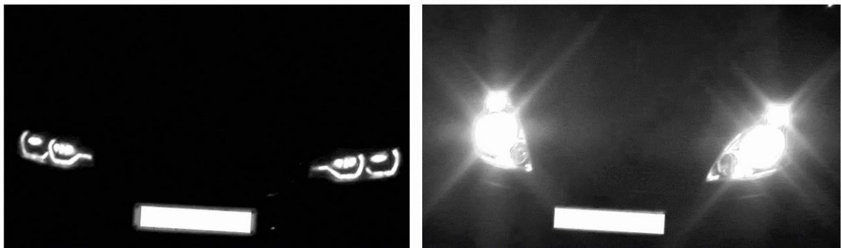
Figure 16. À gauche : la lumière des phares à LED est bloquée par le filtre passe-IR, ce qui réduit efficacement l'éblouissement de l'objectif et la lumière parasite. À droite : la lumière des phares halogènes traverse le filtre passe-IR et provoque l'éblouissement de l'objectif. Les deux images ont été prises presque simultanément, avec des réglages et un alignement identiques, à l'aide d'une caméra équipée d'un filtre passe-IR.
