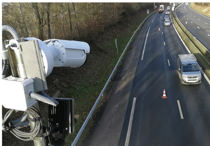
Figure 3. L'assistant de capture de plaques d'immatriculation Axis vous guidera tout au long du processus d'installation et affichera un avertissement lorsqu'un angle est trop large.
