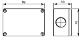
1463FR est une boîte de raccordement pour le câblage de détecteurs. Six bornes sont disponibles pour la mise en série de plusieurs détecteurs sur la même zone d'alarme par exemple.
